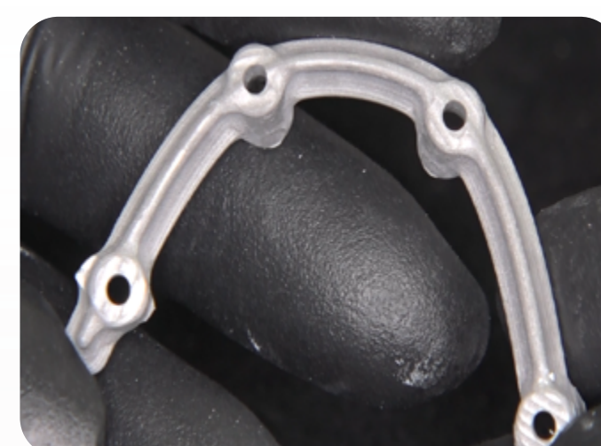
4) Infraestructura colada. Si es necesario, proporcione desgaste interno en las regiones correspondientes a los cilindros calcinables.
