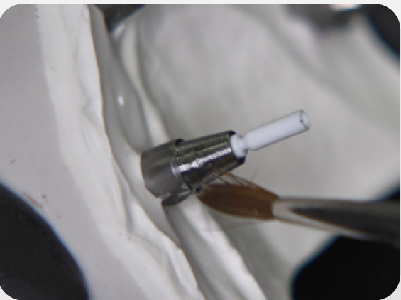
6) Applicare un primer specifico e procedere alla cementazione secondo le indicazioni del produttore del cemento.
